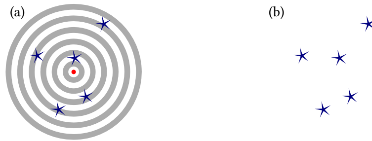
FIGURE 1.2 – Métaphore des cibles (figure a) : un mesurage est comparé à un exercice de tir sur une cible dont le centre (point central, en rouge) représente la « valeur vraie » du mesurande. L'éloignement des données expérimentales (représentées par les croix, en bleu) au centre de la cible représente l'erreur de mesure. Cette métaphore n'est toutefois pas parfaite. Une difficulté de cette métaphore réside dans le fait que, puisque la cible est représentée à un endroit précis, cela peut donner l'impression que l'expérimentateur connaît la valeur vraie, et qu'il peut alors déterminer grâce à cela les erreurs commises. Or, le problème est en fait l'inverse : on cherche à déterminer la position du centre de la cible à partir de celles des données expérimentales, et l'expérimentateur doit pour cela évaluer l'erreur commise. La situation qui apparaît à l'expérimentateur correspond donc à la représentation de la figure (b) plutôt qu'à celle de la figure (a).
